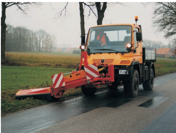
SMT 15 mit ausgefahrener Verschiebeeinrichtung - Verschieberegion 0,65 m
