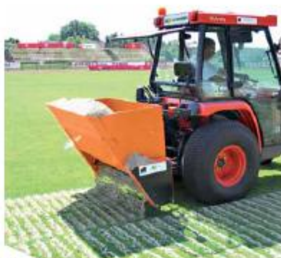
Udlægning af sand på sportspladser
