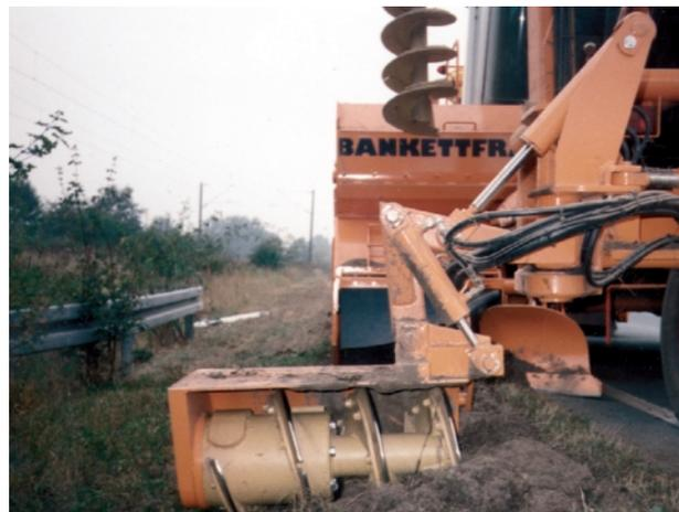
Bankettfräse SBF 900 mit Aussenschnecke montiert an Schnellwechseinrichtung
