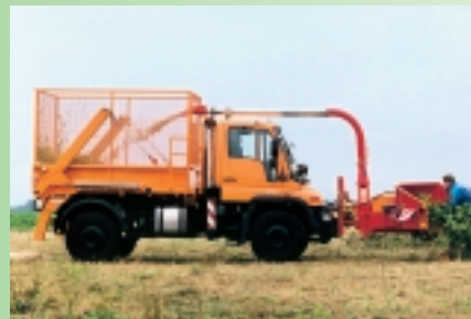
Flishugger med ekstrablæser til transport af flis på ladet af Unimog
