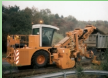
Rabatfræser SBF 900, fremad læsning på vogn.
