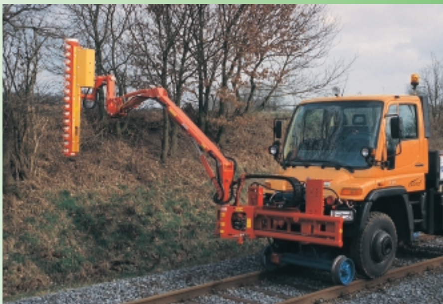
Arm med gren- og hækkesaks AWS 22 på Unimog med skinneføring
