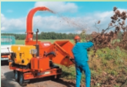
Flishugger HM 250 på trailer med drejkrans 360°
