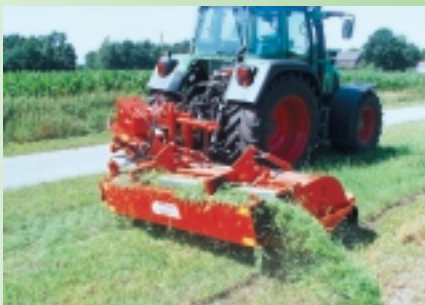
USM med transportbånd til sidelæns udkast af klip- pematerialet
