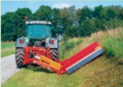
USM 15 klipning af grøft
