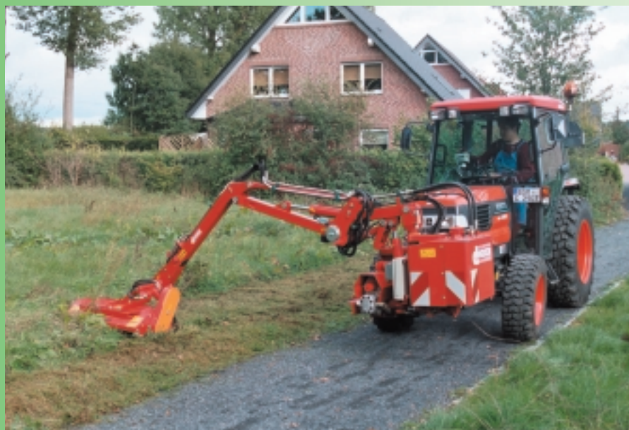
KBM 350 med slagleklipper TMK 10 i arbejdsstilling, frontmonteret, arbejds side højre
