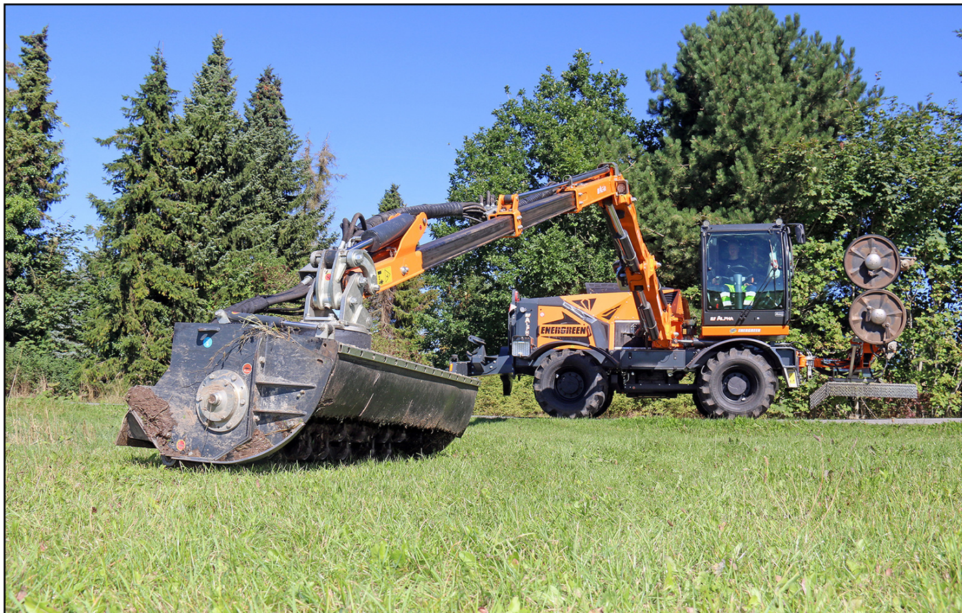
Teleskoparmen kan nå ud på hele 12 meter. Det giver store muligheder både når der skal slås græs, klippes grene ned, renses op i åer og vandløb – og såmænd også til storvask af solpaneler.
