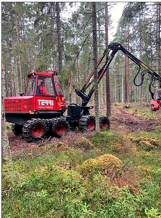
Kranen med teleskop rækker 7,5 meter og er monteret med et Log Max 928-fældehoved.
