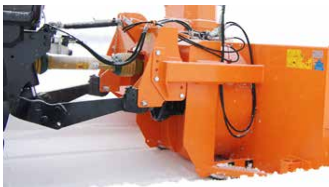
Extra kraftig HD-växellåda för front- och bakmontering (1000 rpm övre tapp / 540 rpm nedre tapp).
