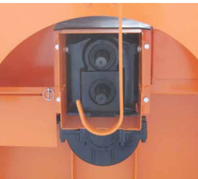
Extra kraftig HD-växellåda för front- och bakmontering (1000 rpm övre tapp / 540 rpm nedre tapp).
