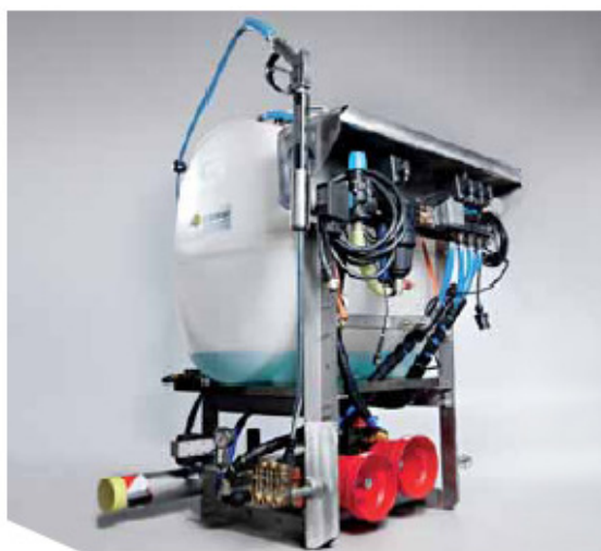
Ice Fighter XF-3RZ med højtryks pumpe 180 bar.
