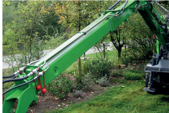
Vollhydraulischer Teleskopausleger mit innenliegendem Verstellzylinder // Fully hydraulic telescopic jip with integrated adjustable cylinder
