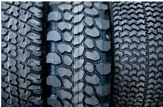
REIFEN // Tires 1. 265 / 75 R 16 2. 315 / 55 R 16 MPT 3. 315 / 55 R 16 Rasenprofil // Lawn profile
