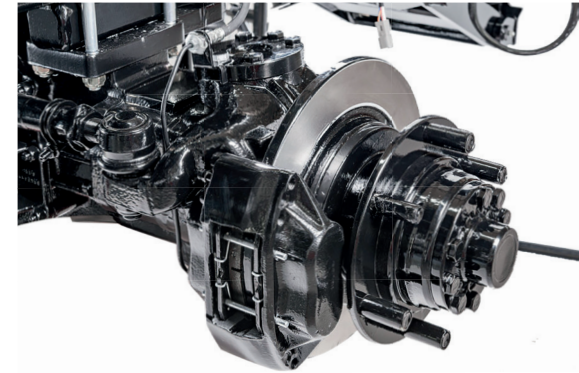
Überdimensionierte Scheibenbremsen mit optischer Verschleißanzeige // Oversized disc brakes with visible wear indication
