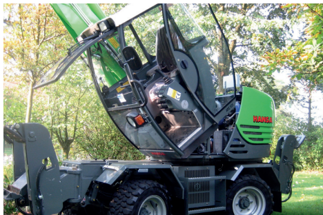
Hydraulisch kippbare Fahrerkabine // Hydraulic tilting driver's cab
