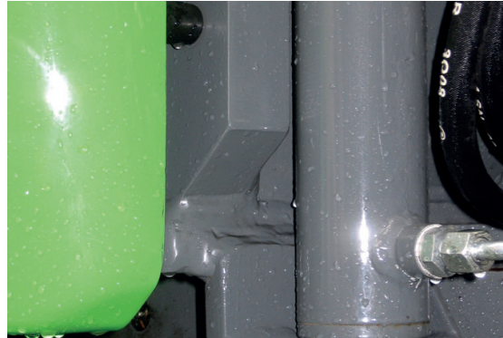
Hydraulische Oberwagenverriegelung bei Straßenfahrten // Hydraulic top carriage locking for/while road use
