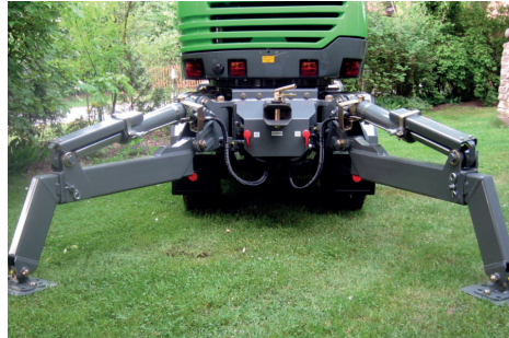
Klappstützen hinten, mechanisch ausziehbar // Foldable rear outrigger, mechanically adjustable
