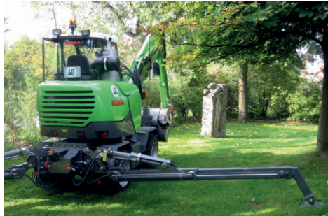
Lange Klappabstützung hinten, hydraulisch stufenlos bis 3.600mm ausfahrbar // Large foldable rear outrigger, hydraulic continuously adjustable up to 3.600mm
