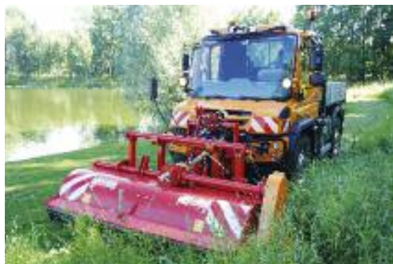
UM 27 i frontmontering med hydraulisk forskydning
