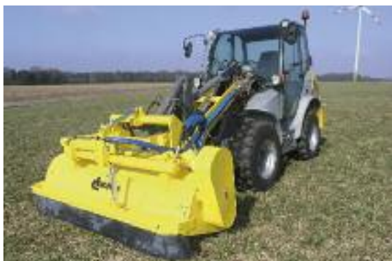
UMK 18 med hydraulisk drev, montering på hjullæsser
